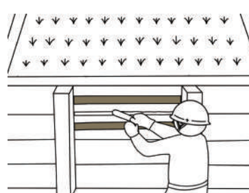
7. シール材をヘラで均します。
