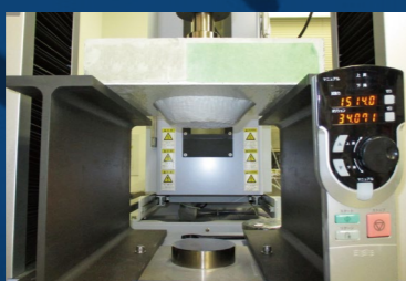
押し抜き試験
